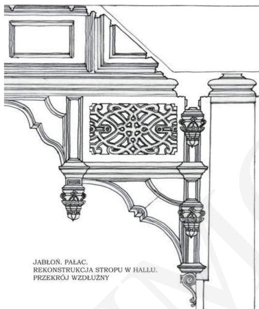
Il. 11. Strop w hallu, przekrój wzdłużny – rekonstrukcja A. Cebulak, 2006.
